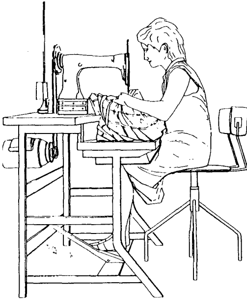
Figura 2 - Posto di lavoro con macchina (la cucire sopraelevata rispetto al piano di lavoro).
